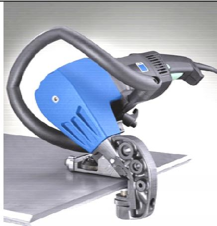
**TKF-1100** : Chanfreineuse portable pour le chanfreinage de tôle et tube (épaisseur 3 à 25 mm) avant soudage. Légère (9.9 kg) mais très performante. Idéale pour l'exécution très rapide de chanfreins (30, 37.5 ou 45°) de qualité, en tout endroit de l'atelier ou du chantier. Réglage simple et rapide sans outil. Grande maniabilité (chanfreine des courbes de rayon 40 mm mini).
