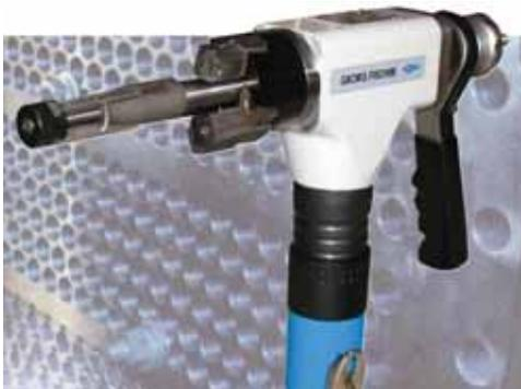
**CHANFREINEUSE BRB** : Machine à façonner les extrémités de tubes par rotation outil coupe, modèle pneumatique portatif (existe aussi en version électrique pour les BRB 4). Pour le dressage ou le chanfreinage (joint en V, en U) des extrémités de tubes (acier, inox) avant soudage. Excellente finition du joint à souder.
