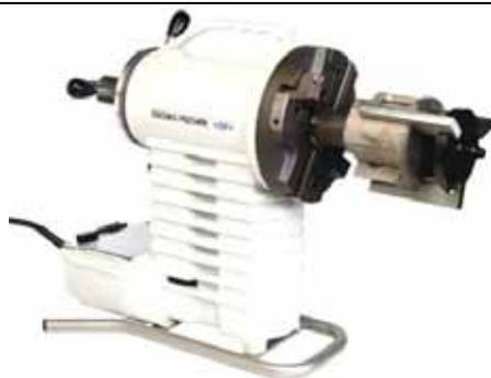
**CHANFREINEUSE REB** : Machine à façonner les extrémités de tubes par rotation outil coupe (0 à 20 trs/minute environ), modèle transportable pneumatique ou électrique. Pour le dressage ou le chanfreinage (joint en V – 30°, 37.5°, ....., en Y ou en U) des extrémités de tubes (acier, inox) avant soudage. Excellente finition du joint à souder.
