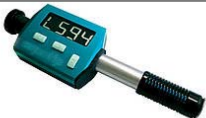
Pointe d'épreuve : carbure tungstène 1500 HV 3 mm
