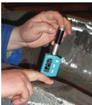
Pointe d'épreuve : carbure tungstène 1500 HV 3 mm
