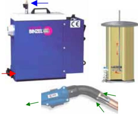
**601.0026** : Aspirateur filtrant (filtre à décolmatage manuel en raccordant l'air comprimé sur le raccord - flèche bleue. Indicateur d'encrassement du filtre. Dédié aux torches MIG aspirantes (gaine dia 50 mm). Filtre norme EN 60335-2-69 classe M. Tiroir récupération poussières-flèche rouge.
