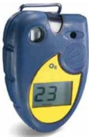
**TOXIPRO** : Mesureur de niveau d'oxygène. Le soudage dans des enceintes confinées (citernes, caissons,...) conduit au risque de sous-oxygénation : progressivement, la teneur en oxygène de l'air ambiant diminue de 21% à 17% et moins. La vigilance du soudeur diminue jusqu'à la perte de connaissance et l'asphyxie. Le TOXIPRO prévient le soudeur par alarmes sonore, vibrante et visuelle que la teneur en oxygène atteint un seuil critique.
