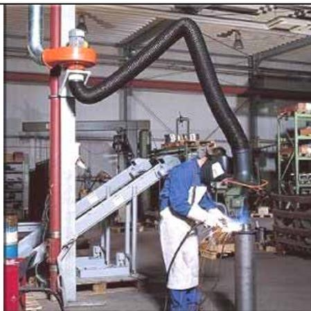
**Bras articulés basse dépression** : Les bras articulés (structure porteuse à double parallélogramme avec ressorts de compensation) sont conçus pour l'aspiration à la source des fumées de soudage, des gaz, vapeurs, poussières. Ils sont composés d'une console murale et d'une hotte d'aspiration avec clapet de débit.
