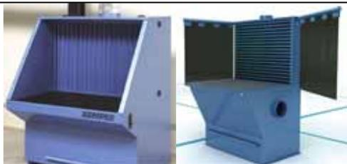
**Table de meulage :** Construction robuste mécano-soudée, avec caillebotis, tiroir à scories. Aspiration par le bas et le mur arrière. Avec 2 retours latéraux.
