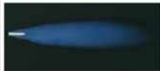
Flamme oxydante (mal réglée)
